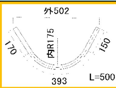
現在力を入れているHARDOXの曲げにおいて、厚板の曲げの難易度が高い中、HARDOX450 t25のR曲げに初挑戦し、成功しました！耐摩耗鋼の加工は是非当社にご相談下さい。
